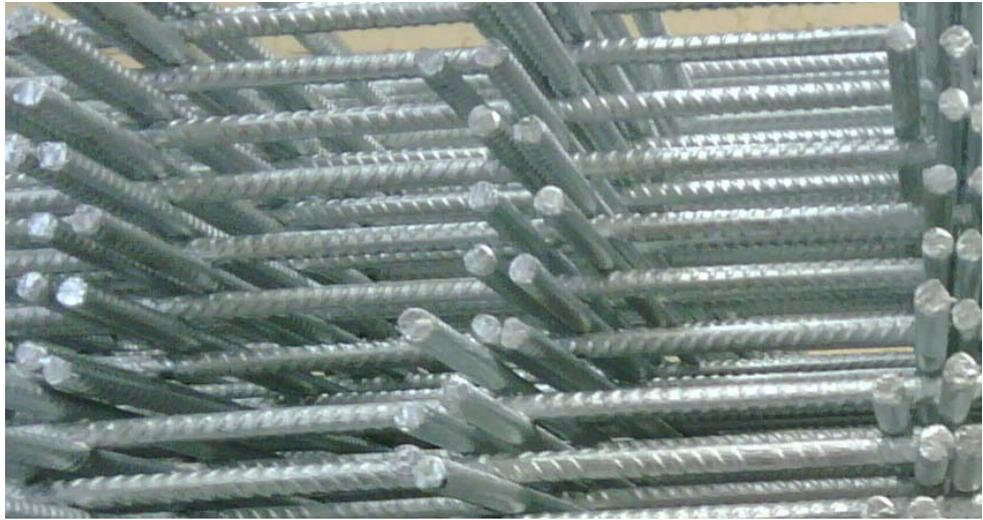
El galvanizado en caliente es un proceso que logra la protección frente a la corrosión de toda clase de piezas de hierro y acero por inmersión de los mismos en un crisol de zinc fundido. Este recubrimiento tiene una adherencia muy superior a la pintura, ya que se produce una aleación con el acero base.
